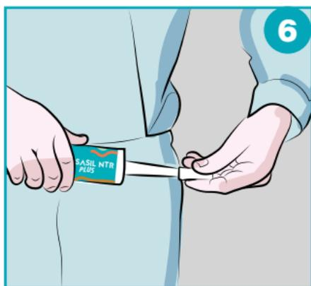
Couper l'embout plastique à 45 degrés en fonction des dimensions du joint.
