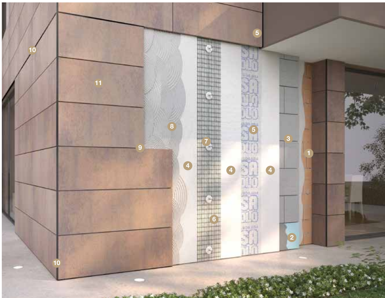
L'image ci-dessus illustre le Cycle Rivesto avec la solution Panneau en PSE + Colle et couche de base A 50
