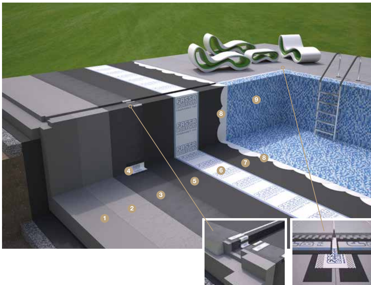
Détail imperméabilisation canal périphérique
