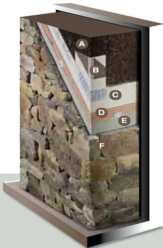
**A.** Panneau isolant en liège encollé avec de la colle A 96, méthode sur bordure périmétrale et lignes ou sur surface totale
