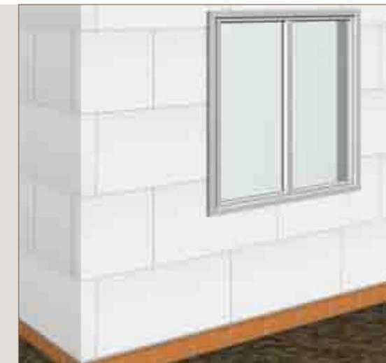
Les joints entre panneaux doivent être remplis de bandes de matériau isolant. Pour des joints de moins de 4 mm, on peut se servir de la mousse de remplissage polyuréthane FASSA Mousse. Ne jamais utiliser de mortier-colle pour remplir des espaces vides entre panneaux.
