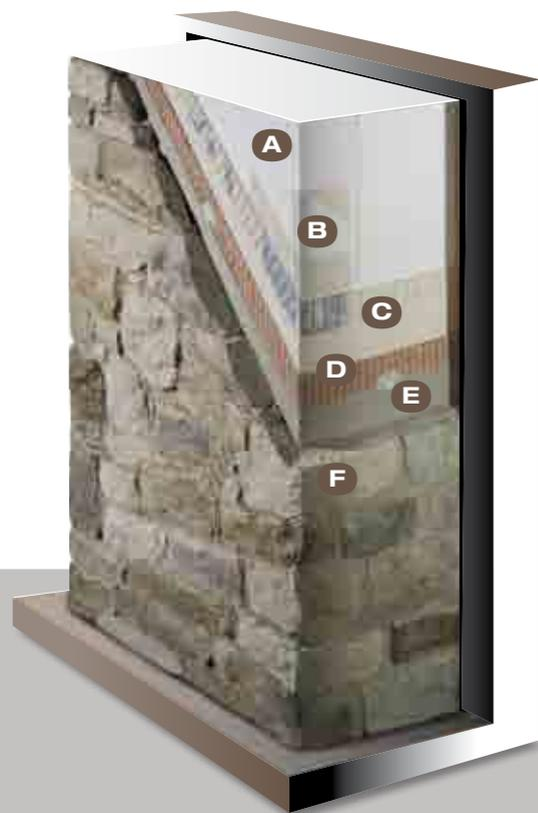
**A.** Panneau isolant en EPS encollé avec de la colle A 96, méthode sur bordure périmétrale et lignes ou sur surface totale
