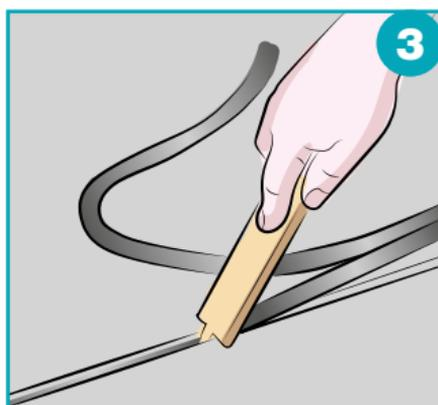
Per aumentare la durabilità della sigillatura, il sigillante elastico dovrà aderire solo ai bordi del giunto e non al fondo; per ottenere ciò è necessario inserire all'interno del giunto il cordone comprimibile **FASSAFOAM** di diametro idoneo (maggiore rispetto alla larghezza del giunto). Il battiscopa perimetrale verrà incollato sulle pareti interponendo sul pavimento adeguati cunei distanziatori al fine di lasciare uno spazio minimo di 3 mm che sarà
