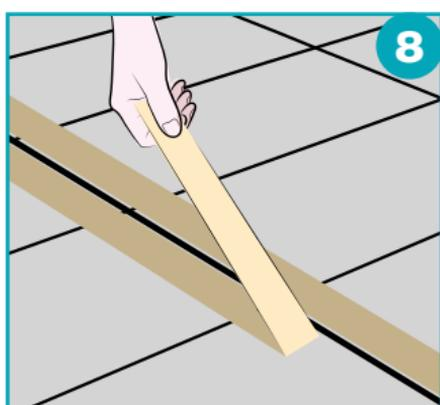
Inumidire con acqua saponata una spatola per lisciare il sigillante e garantirne il contatto lungo i bordi, rimuovendone l'eccesso. Rimuovere il nastro di mascheratura prima che **FASSASIL NTR PLUS** indurisca. Una volta indurito, il prodotto può
