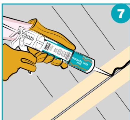
Sul supporto adeguatamente preparato, applicare il sigillante elastico, utilizzando una pistola erogatrice, estrudendolo nel giunto a totale riempimento, evitando sovrapposizioni di prodotto che
