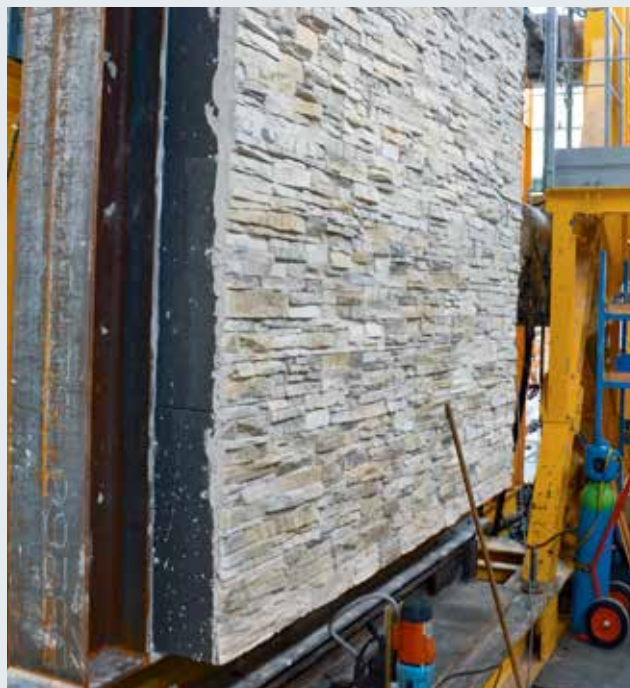
murogeopietra su Fassatherm® EPS sp. 200 mm
