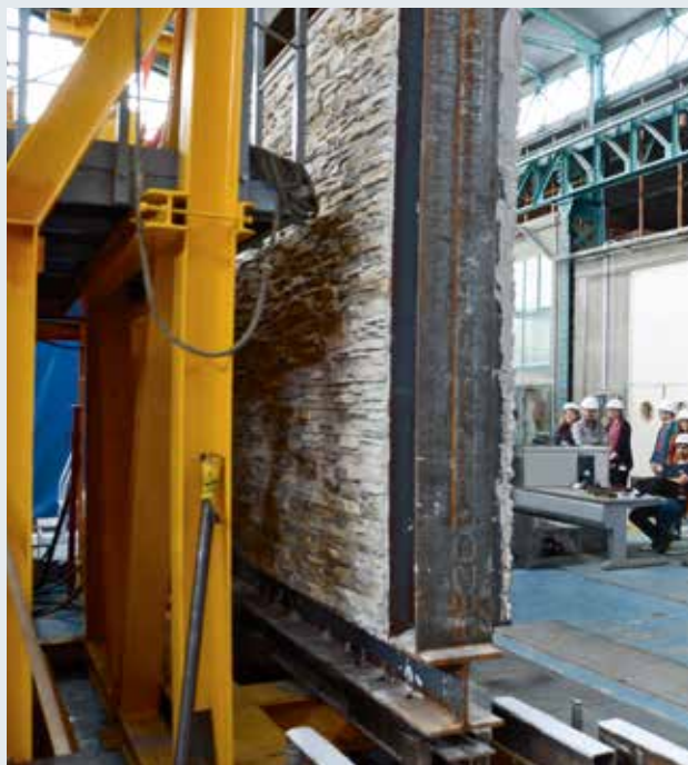
murogeopietra su blocchetti di cemento
