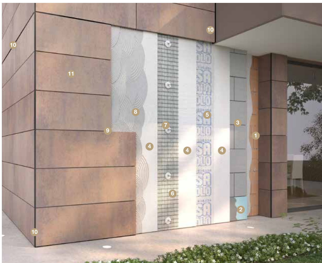
Die hier abgebildete Veranschaulichung zeigt den Zyklus Rivesto mit der Lösung EPS-Dämmplatten + Spachtelkleber A 50 auf.
