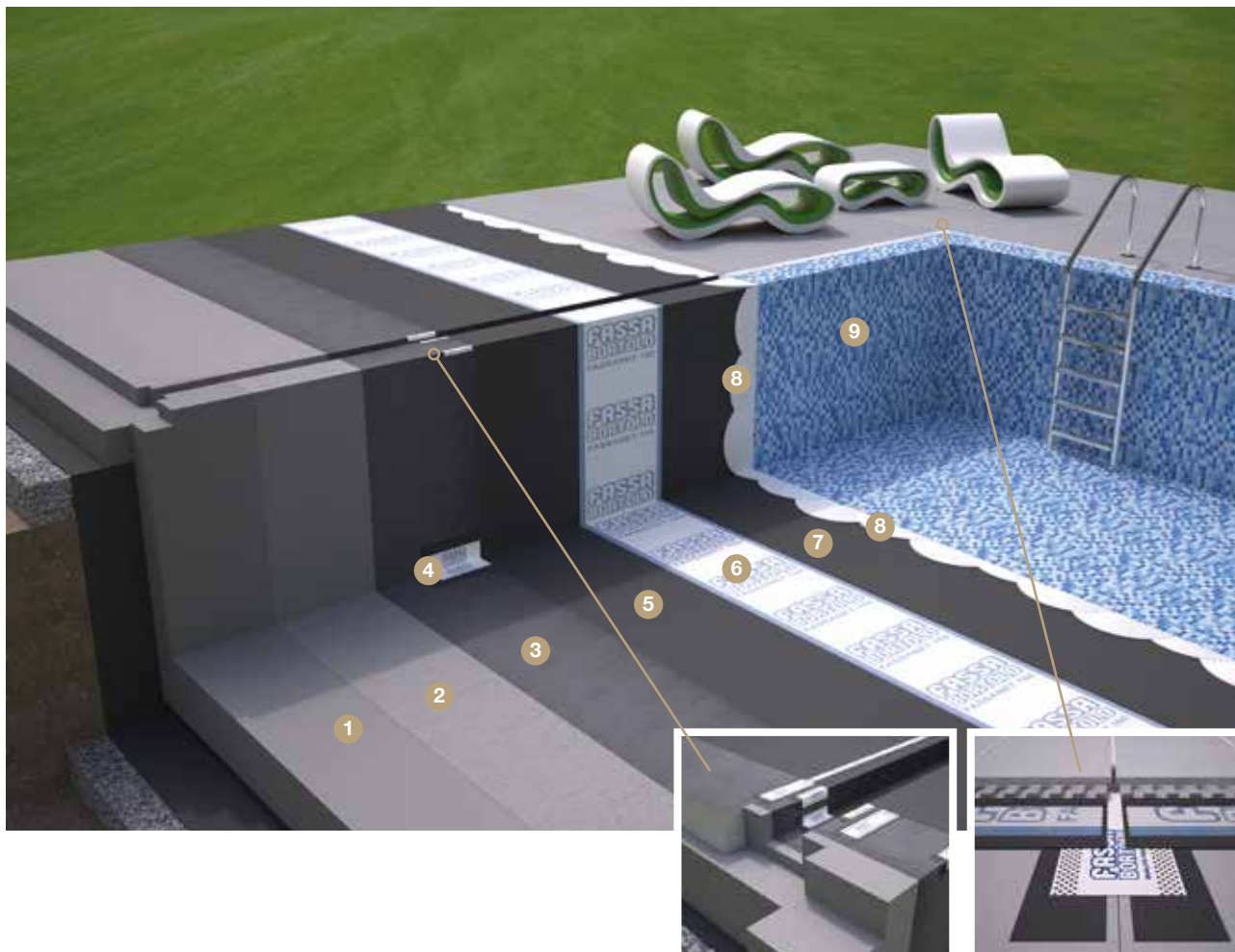
Detail Abdichtung Umfangsrinne
