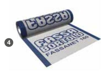
Alkalibeständiges Armierungsgewebe aus Glasfaser, 160 g/m<sup>2</sup>, Maschengröße 4,15 x 3,8 mm.
