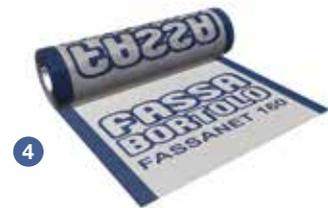
Alkalibeständiges Armierungsgewebe aus Glasfaser, 160 g/m<sup>2</sup>, Maschengröße 4,15 x 3,8 mm.
