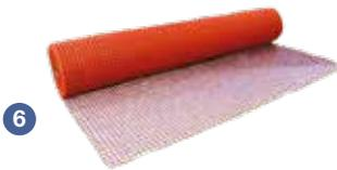
Äußerst robustes, alkalibeständiges Glasfasergewebe, 315 g/m<sup>2</sup>, Maschengröße 15 x 15 mm.
