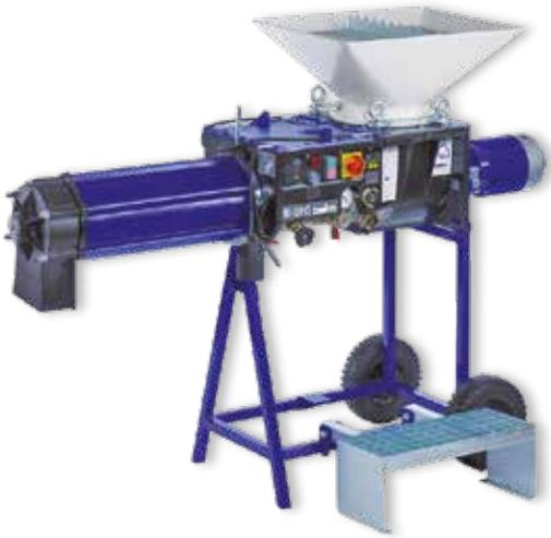
Ausgezeichnete Eigenschaften, was Reinigung und Instandhaltung betrifft, mit Polyurethankomponenten, die die Lebensdauer des Produkts erhöhen und nicht korrodieren. Stets gleichbleibende Qualität der Produktmischung, da das Verhältnis zwischen Trockenmaterial und Wasser immer konstant bleibt.
