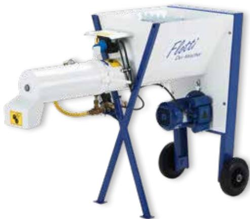
Einphasenmischer, der Elektromischer und Betonmischmaschine ersetzt. Besitzt eine Produktionsleistung von 20 l/min. und liefert eine gleichbleibende und einheitliche Mischqualität. Kann dank des 230-V-Motors mit Strom, der normalerweise in Wohngebäuden zur Verfügung steht, über Schuko-Anschluss versorgt werden. Einfach und schnell zu reinigender Mischer.
